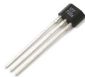
Slika 1. Elektromagnetni senzor na bazi Holovog efekta
